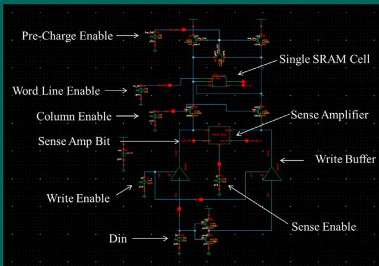
Fig. 2. SRAM module
